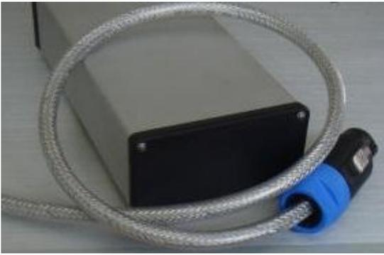
C'est la source d'énergie, très généreuse, du Maestro 3. Elle contient 2 transformateurs toroïdaux de 100 VA chacun et pèse 3 Kg. Le Maestro 3 Ref va plus loin avec 2 transformateurs de 350 VA chacun pour 11 Kg. La liaison au corps du convertisseur se fait par un câble d'assez forte section et blindé. Un système de sécurité vient verrouiller le branchement à l'arrière du convertisseur.
