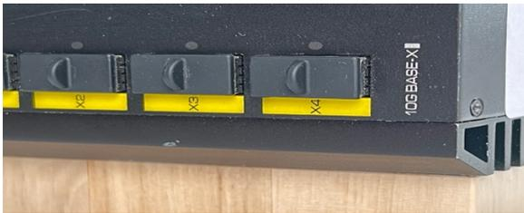
4 ports SFP avec un débit cuivre ou fibre de 10Gbits. Cela permet de d'optimiser le câble RJ45 provenant de la box internet.
